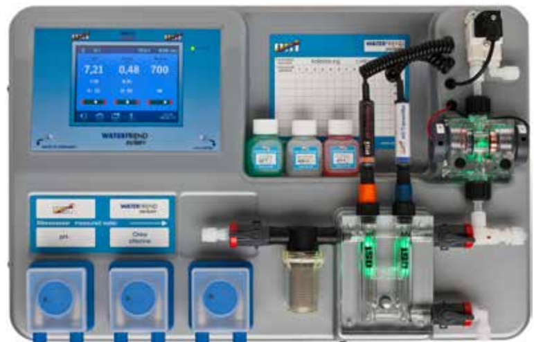
Die Dosieranlage „WATERFRIEND MRD-3“ von osf Hansjürgen Meier bietet freie Chlormessung sowie Redox- und pH-Regelung. Die Anlage beinhaltet einen farbigen Touchscreen-Monitor mit grafischer Oberfläche und benutzerfreundlicher Menüführung sowie einem Web-Server. Serienmäßig mit Internetanschluss. ( www.osf.de )
