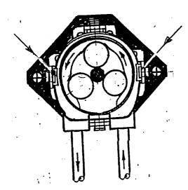
Monatlich überprüfen, ob die Dosierschläuche an den Anschlüssen feucht sind, d.h. undicht. Wenn ja, sofort Dosierkassette auswechseln und Dosierventil überprüfen.
