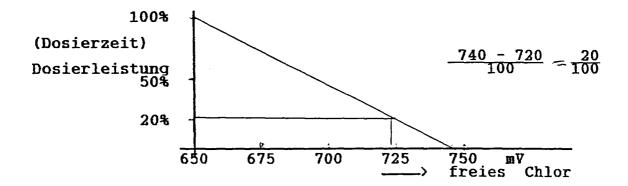
Im Beispiel fördert die Desinfektionspumpe alle 2 Minuten 10 Sekunden und dosiert hierbei ca. 8 ml/Zyklus, in der Stunde ca. 250 ml. Bei 8 Stunden Betriebszeit wäre der Verbrauch 2 Liter Desinfektionsmittel, wenn in dieser Zeit der Verbrauch (= Regelabweichung) konstant bleibt.
