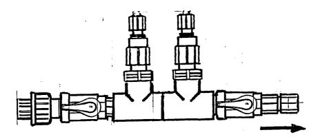
Die Chemikalien werden durch federbelastete Kugelventile (17) in das Dosierrohr eingespeist. Die beim Dosieren von Chlorlösung gefürchtete Blockierung des Dosierventils durch Kalkablagerungen wird weitgehend reduziert, da die dosierte Säure über die Chlordosieröffnung strömt. **Die Impfventile sind ebenfalls farblich gekennzeichnet. Chlor = gelb, Säure = rot.**
