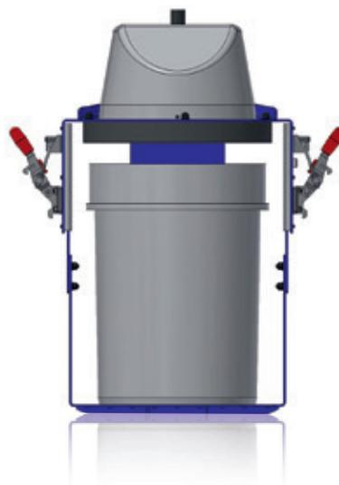
Das zu verwendende Fass wird in den Haltebügel eingesetzt und durch die Bestätigung zweier Spannhebel gegen den Dosierkopf gedrückt. Damit wird eine sichere, feste und dichte Verbindung zwischen Fass und Dosierkopf sichergestellt. Anschließend wird die komplette Einheit gedreht und in die Dosierposition gebracht. Bei einem Wechsel des Fassstyps sind nur wenige Anpassungen vorzunehmen.
