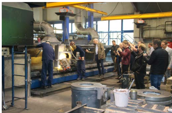
Spektakuläre Szenen sahen die Gäste in der Gießerei: Mit 1 260 Grad werden die Eisenrohlinge geschmolzen und in die Modelle und Formen gegossen.
