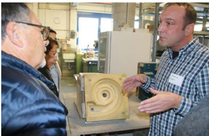
Rund 1 000 Modelle und Formen hat Hugo Lahme vorrätig. Johannes Hafer, Beauftragter fürs Qualitätsmanagement, erklärt hier das Modell eines Pumpengehäuses.
