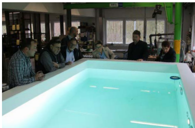
Am Ende des Produktionsprozesses müssen sich Unterwasserscheinwerfer, Gegenstromanlage und alle anderen Einbauteile im Testpool bewähren – vor allem in puncto Dichtigkeit.
