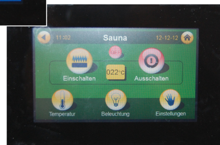
Mit nur einem Display können Saunakabine und Dampfbad gleichzeitig gesteuert werden.
